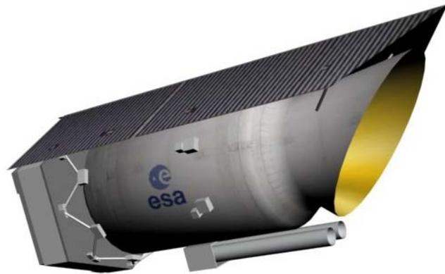
Le miroir d'ISO mesure 70 centimètres de diamètre et quatre groupes d'instruments sont à bord: CAM deux caméras dans l'infrarouge proche et moyen, avec des roues à filtre. PHOT des spectromètres/imageurs couvrant une large gamme spectrale de 5 à 210  $\mu\text{m}$  ; SWS un spectrographe dans la gamme 5 à 35  $\mu\text{m}$  ; LWS un spectrographe dans la gamme 35 à 205  $\mu\text{m}$ .
